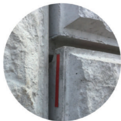
フェイルセンサー作動時 (赤色の変状サインで内部異常を可視化)
